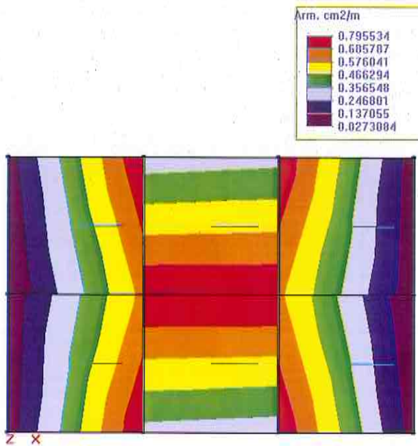
ARMATURA MINIMA SUPERIORE DIR X
